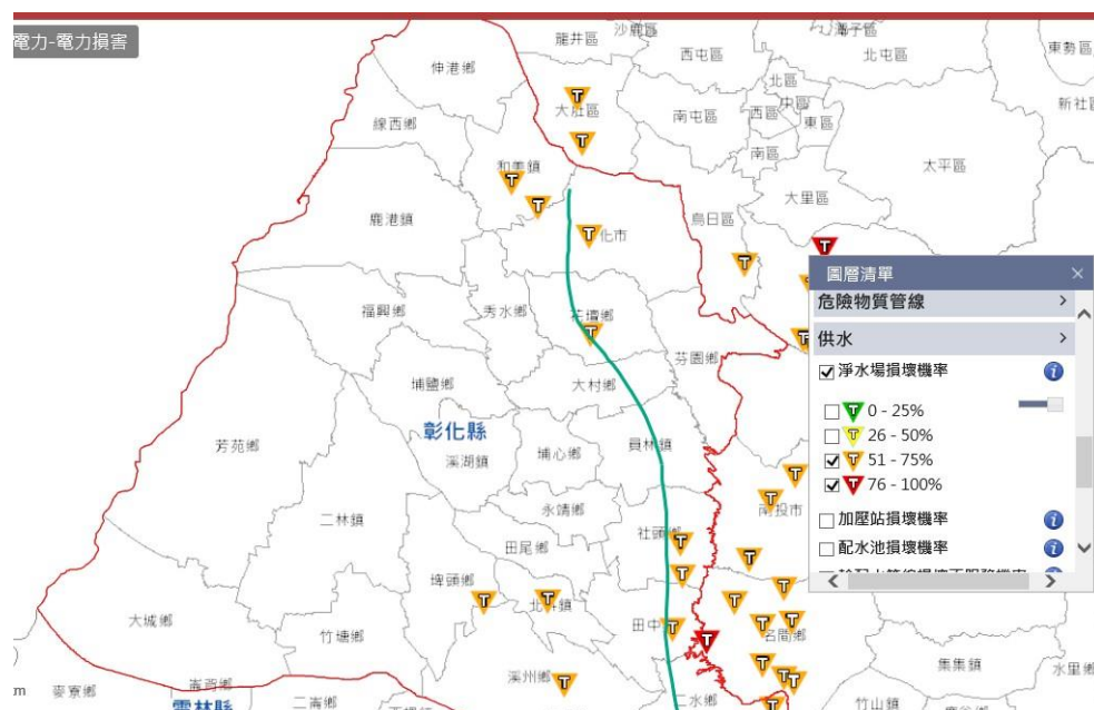
圖1-3-10模擬淨水廠損壞機率
