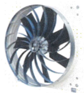
SEF42-7D 42吋七葉 規格: 106x106cm 馬力: 1HP 風葉: 36吋七葉塑鋼風葉 抽風量: 18,000CMH
